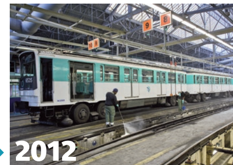
Ateliers d'Italie, maintenance du matériel roulant MP73
